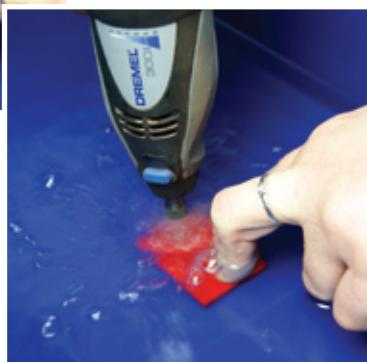
Fyll litt vann i et egnet kar, legg en glassplate eller isopor i bunnen for å hindre at du borer gjennom karet. Legg så glassbiten din oppi karet, den skal være dekket av vann. Før boret mot punktet du vil bore, men hold boret PÅ SKRÅ. Når boret har fått grep i glasset retter du det rolig opp i loddrett stilling. Fortsett til du kjenner at boret har gått gjennom glasset.
